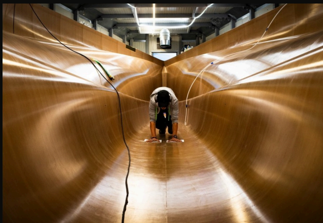
Rompvoorbereiding. De mal wordt voorbereid en koolstofvezelpanelen worden gelegd. © Ferrari
