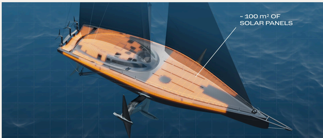
Officiële render: 100 m 2 zonnepanelen geïntegreerd in dek en rompzijden. © Ferrari
