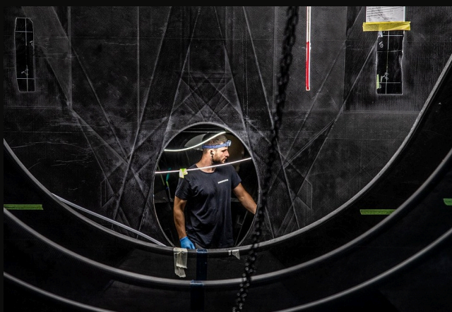
Interne structuur. Kajuitopbouw en interne rompstructuren worden gelamineerd en gevormd. © Ferrari
