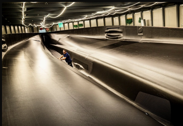
Uitharden. Koolstoflagen worden vacuüm geperst en verhit tot een compact composiet. © Ferrari
